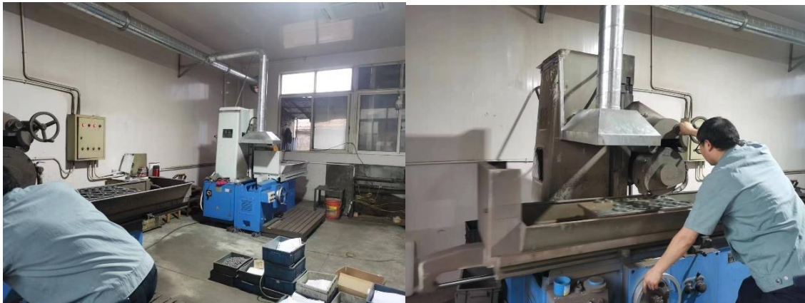
图 3.1-1 研磨设备及废气收集装置
