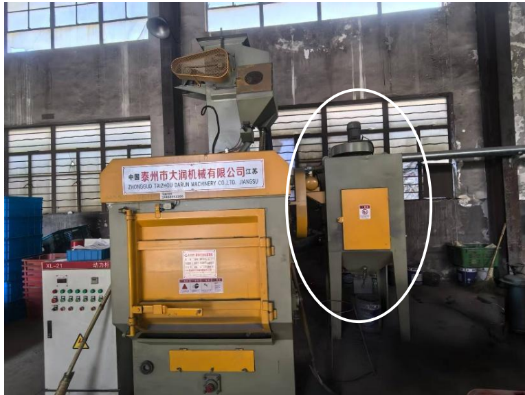
履带式抛丸清理机及配套布袋除尘器
