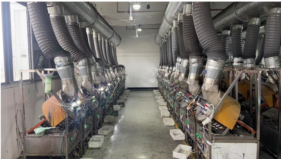
图 3.1-4 滚喷机现场照片
